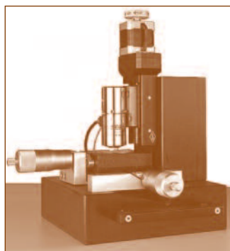
Il microscopio a forza atomica consiste di una microleva (cantilever) alla cui estremità è montata una punta acuminata (tip) che presenta un raggio di curvatura dell'ordine dei nanometri.
